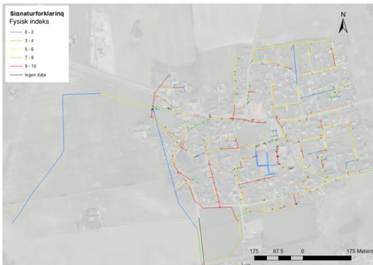
Figur B5 Gennemførte TV-inspektioner, Nord
